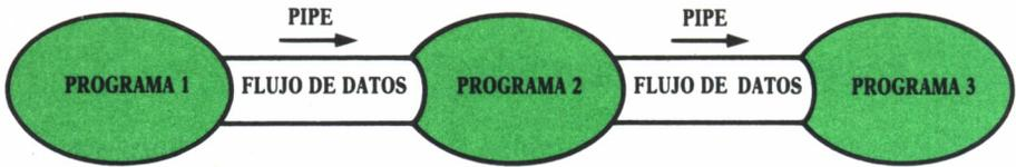
Fig. 3.2. Conexión de programas mediante pipes.
